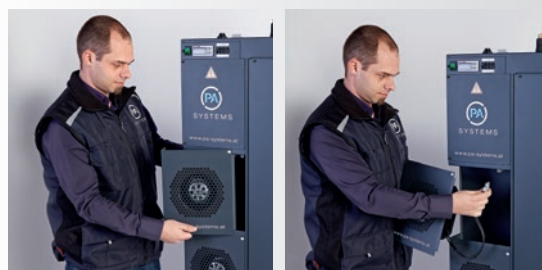
Ventilatoraustausch im laufenden Betrieb
